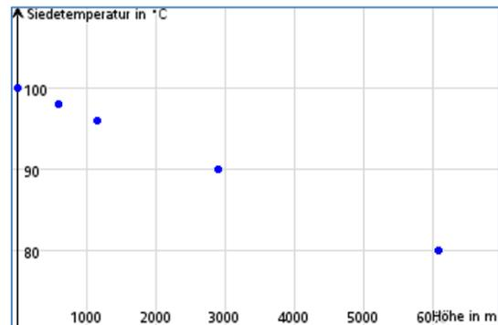
b) Individuelle Lösung: Es wird nach Augenmaß eine „möglichst gut passende“ Gerade durch die Punkte gelegt. Sie hat näherungsweise den Anstieg  $-\frac{20}{6000} = -\frac{1}{300} \approx -0,0033$ . Der Durchgang an der y-Achse ist bei 100, so dass die Ausgleichsgerade näherungsweise die Gleichung  $f(x) = -0,0033x + 100$  hat.
