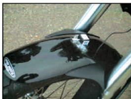
Abb. 23 - Beschleunigungssensor auf der Radabdeckung der BMW G 650.
